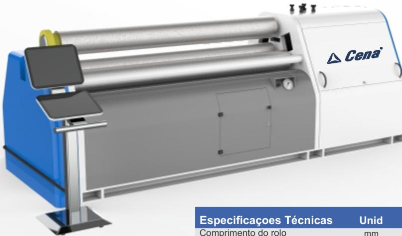
Calandra hidráulica CENA® com inicial, 4 rolos, dispositivo de cones, inclinação dos rolos laterais e inferior central, eixos montados em rolamentos, duas velocidades de trabalho, redutor planetário com motor hidráulico, painel de comando móvel com display digital e sistema de segurança. Possui também opcionais como sistema de controle CNC ou NC, suporte central da virola, suportes laterais da virola e mesa de alimentação.
